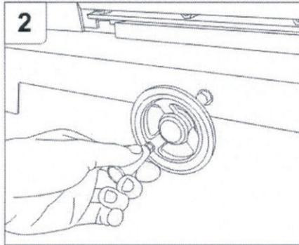
2 Coloque as folhas e ajuste o esquadro através do Volante Frontal.
