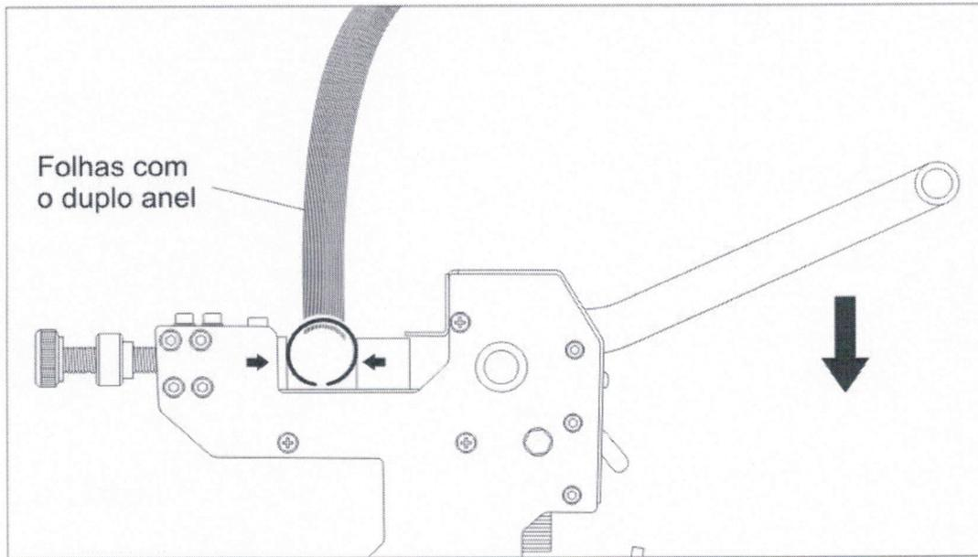
Após o ajuste, coloque o duplo anel com as folhas, entre os mordentes e utilize a mesma alavanca que você usa para a perfuração, para executar o fechamento dos duplos anéis.
