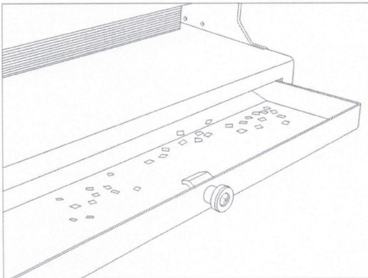
na parte traseira do equipamento existe uma gaveta onde ficam armazenadas os picotes das perfurações.
